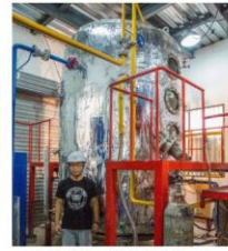
安全壳穹顶冷凝验证平台
