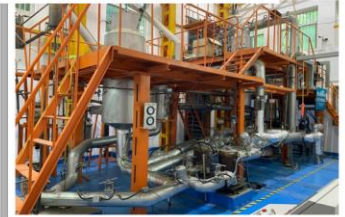
钠冷快堆、铅铋堆、熔盐堆等先进核动力系统热工安全验证平台
