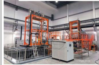
钠冷快堆、铅铋堆、熔盐堆等先进核动力系统热工安全验证平台
