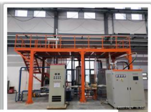
钠冷快堆、铅铋堆、熔盐堆等先进核动力系统热工安全验证平台
