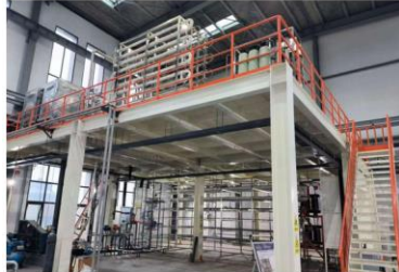
压水堆非能动余热排出系统机理试验平台
